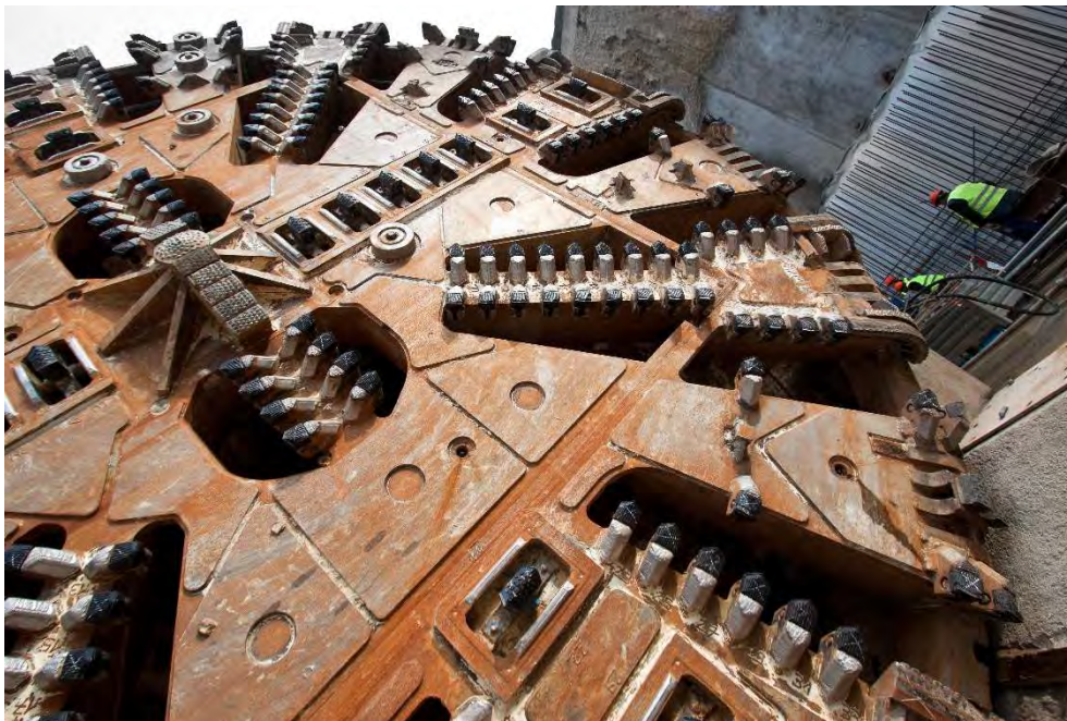
Abb. Bohrkopf einer Tunnelbohrmaschine
